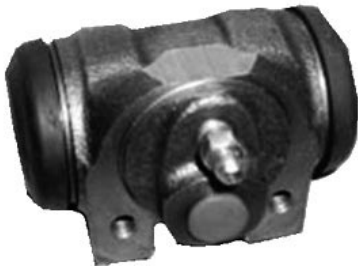
3690 CILINDRETTO FRENI POST. FIAT 500 F/L GIARDINIERA (REAR WHEEL BRAKE CYLINDER)
