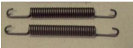
3837 MOLLA RICHIAMO GANASCE FRENO FIAT 500 N/D/F/L/R (BRAKE SHOE SPRING) (ad.891725)
