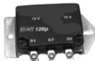
3769/1 REGOLATORE DI TENSIONE 500/126/600/850 ELETTRONICO (ELECTRICAL VOLTAGE REGULATOR)
