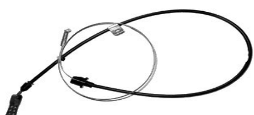
CV005 CAVO MOTORINO AVVIAM. 500 D ATTACCO "L" (STARTER CABLE 500D "L" CONNECTION)
