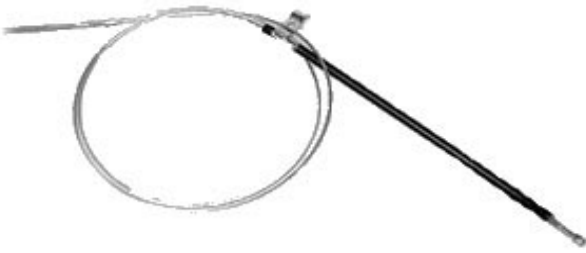
CV008 CAVO FRIZIONE FIAT 500 R FIAT 126 (CLUTCH CABLE 500R/126)
