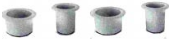
3796/2 KIT BOCCOLE PEDALIERA FIAT 500 N/D/F 1 SERIE (BUSH KIT FOR PEDAL GROUP) (AD.986145)
